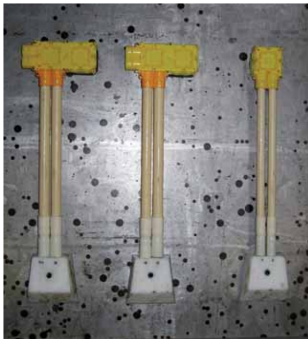
Figur 21. Som alternativ til polystyrenklodser er der her anvendt udsparingsklodser af kunststof med indbyggede magneter. Klodserne er koniske for at muliggøre af-formning på fabrikken. Klodserne genbruges.
