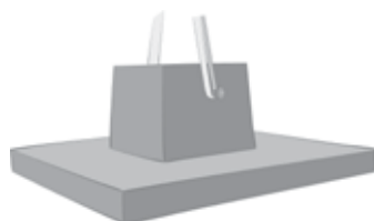
Figur: Punktfundament typ 1
